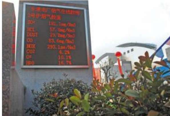
图 25：永康垃圾焚烧电厂在线烟气监测显示屏
